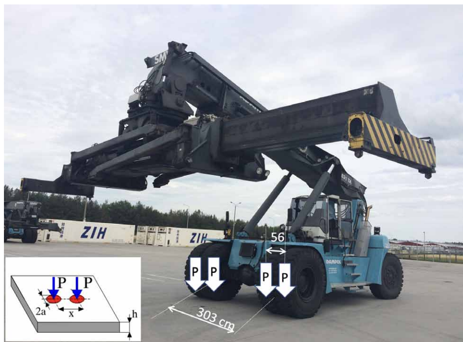
Rys. 2. Schemat przekazywania obciążeń od dźwigów kołowych.
