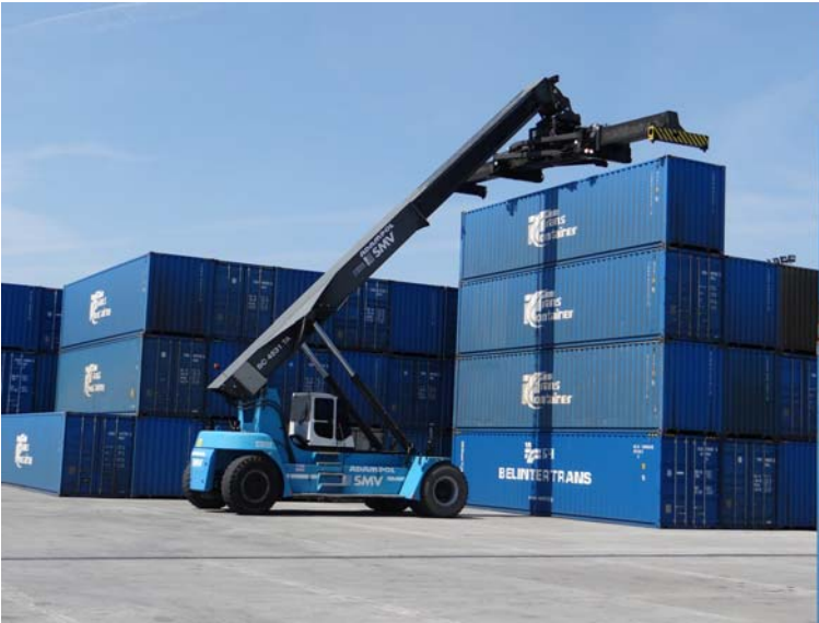
Fot. 5. Ustawienie kontenerów w stosy o masie do 120 t
